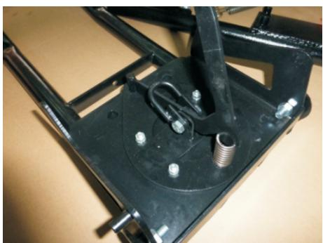
3.6. Соедините навеску и отвал с помощью болта, шайбы, гайки, так чтобы дистанционная увеличенная шайба Ø35 оказалась внутри отверстия отвала.
