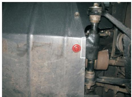
3.3. Установите площадку крепления навески, используя скобы и гайки, как показано на фото.
