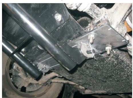
3.4. Установите поперечную балку с площадкой под лебедку с помощью стремянок на кронштейны крепления бампера.
