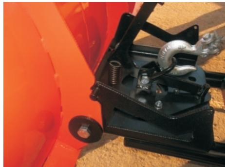
3.7 Закрепите возвратные пружины с помощью стяжек входящих в комплект поставки.
