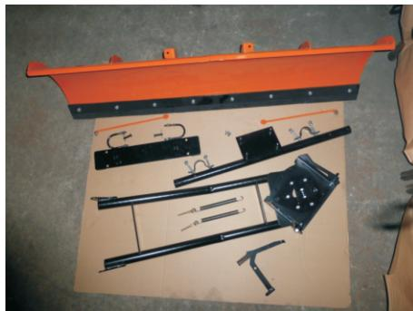
3.2. Кронштейн крепления рамы крепится к передней балке автомобиля. При необходимости сделать вырезы в защите картера двигателя под скобы, как показано на фото.
